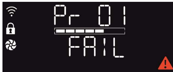
Anzeige „FAIL“ im Anschluss an einen Alarm
