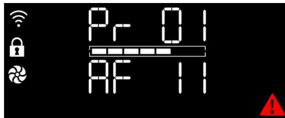
Beispiel der Anzeige des Alarmcodes und des Alarmsymbols
