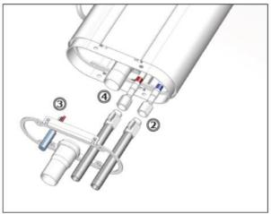
Schließen Sie den Wasseranschluss @ und den Stromanschluss @ an und verbinden Sie das Abflussrohr @ unten mit dem Rückschlagventil.
