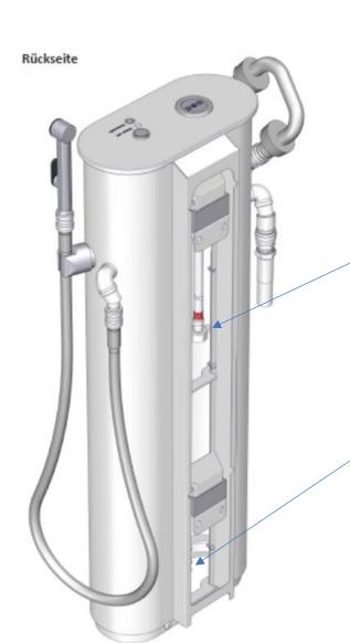
C: Die Säule ist auf der Rückseite offen und es ist daher möglich, Wasserversorgung und Strom direkt von Wand zu Säule zu verbinden und somit die Versorgung durch den Boden zu versagen.
