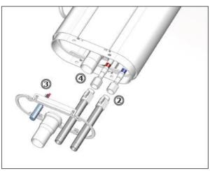
Schließen Sie den Wasseranschluss @ und den Stromanschluss @ an und verbinden Sie das Abflussrohr @ unten mit dem Rückschlagventil.
