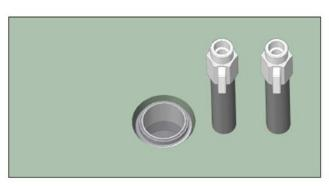
4Die Absperrventile müssen ca. 150 mm über Bodenniveau montiert werden.
