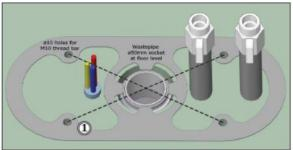
6 Richten Sie die Bohrschablone exakt an der Abflussöffnung aus. Bohren Sie mit Hilfe dieser Schablone die Löcher ® für die Wasseranschlusseinheit.
