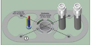
6 Richten Sie die Bohrschablone exakt an der Abflussöffnung aus. Bohren Sie mit Hilfe dieser Schablone die Löcher ① für die Wasseranschlusseinheit.
