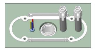
Ziehen Sie die untere Halterung von der Wasseranschlusseinheit ab und befestigen Sie sie mit Spreizbolzen oder Klebeankern mit Gewindestangen am Boden.
