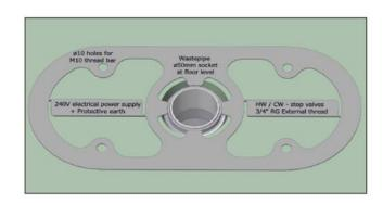
Rechts von der Säule müssen die Kalt- und Warmwasseranschlüsse montiert werden. Verwenden Sie dazu die 3/4-Zoll-Rohre mit Außengewinde und Absperrventil.
