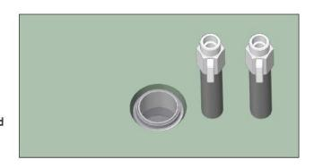
4 Die Absperrventile müssen ca. 150 mm über Bodenniveau montiert werden.
