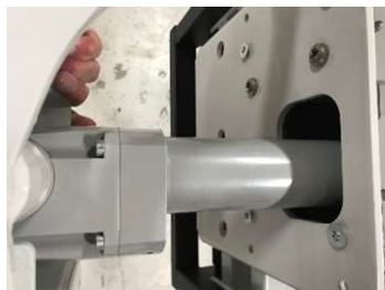
Pumpe herausziehen / Pumpe montieren
