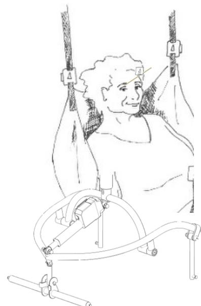
Befestigen Sie die Clips der Verbreiterungsstange an den Aufhängepunkten der Beine des 4-Punkt Hebebügels, indem Sie den orangenen Bügel nach unten drücken und die Clips über die Aufhängepunkte legen.
