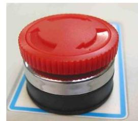
Durch Drehen des **NOT-AUS-Kopfes** im Uhrzeigersinn springt dieser heraus und ist entriegelt. Der Antrieb kann wieder über den Handschalter angesteuert werden.
