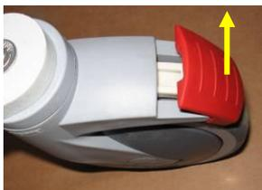
Das Lösen der Räder erfolgt durch Anheben des Betätigungshebels mit dem Fuß nach oben.
