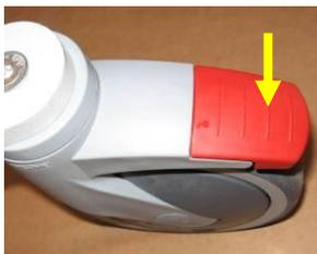
Drücken Sie mit dem Fuß die Radfeststeller nach unten. Die Räder sind nun gebremst und richtungsfestgestellt. Achten Sie darauf, dass die Räder möglichst nicht nach innen weisen.
